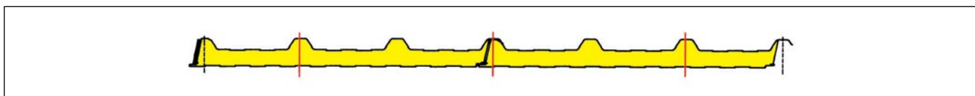
ECOPANEL® RL - Ενδιάμεσα πάνελ: 2 αυτοδιατρητικές βίδες ανά τεγίδα.
